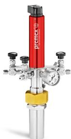
Gezeigt wird der Reaktor andorra mit einem Nennvolumen von 60 ml oder 100 ml, 230 bar und 250°C. Er bildet das Basismodell. Erweitert um eine Doppelmantel- oder Elektroheizung wird aus diesem Batch Reaktor der apart.
