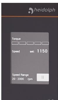
Modernes digitales 2,4" Display für eine intuitive Bedienung. Anzeige der Drehmomenttendenz um Viskositätsveränderungen zu erkennen.
